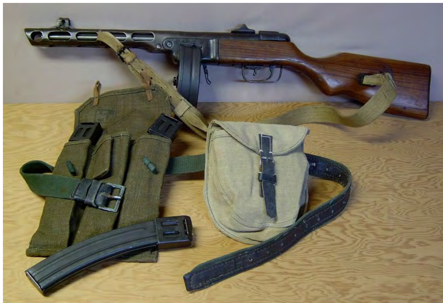
ППШ-41 с подсумками для магазинов: коробчатых (на 35 патронов) и дисковым (на 71 патрон)
